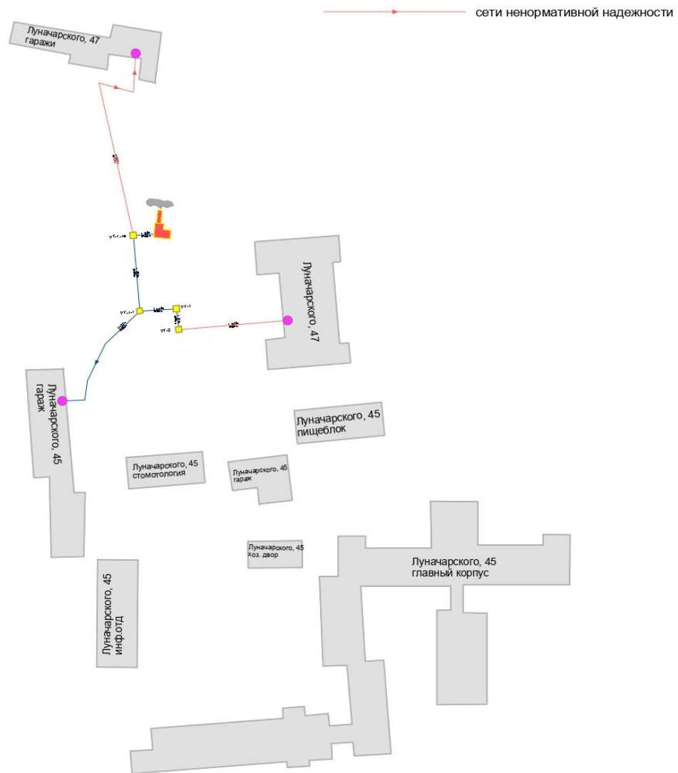
Рис.22. Сети ненормативной надежности котельной ул. Луначарского, 47.
